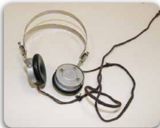
Căști din ebonită și oțel folosite în centralele telefonice și în studiourile de radio ale vremii Producător: Ericsson An: 1929 Expozant: Cătălin Victor Mitrescu, ANCOM
